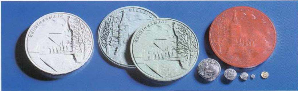
2 Arbeitsweise: Gipsmodell, Silikonabguß, Abtastmodell Duroplast, verschiedene Werkstückgrößen
