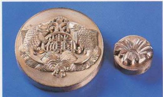
5 Erodiererelektroden für den Werkzeugbau
