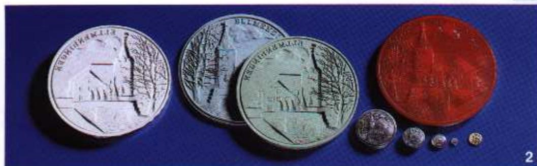
2 Arbeitsweise: Gipsmodell, Silikonabguß, Abtastmodell Duroplast, verschiedene Werkstückgrößen
